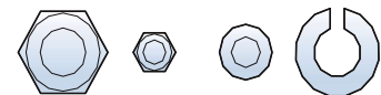
Гайка M5: 4 шт., Гайка M10, шайба стопорная, шайба плоская для 3-полюсного – 12 шт., для 4-полюсного – 16 шт.
